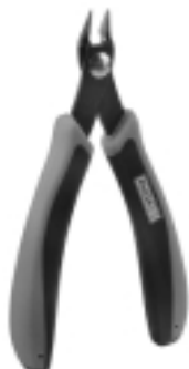
170688 Spezial-Seitenschneider zum gratfreien Abtrennen von feinsten Spritzteilen. Spitze 48° abgewinkelt. Nur für Polystyrol geeignet.
