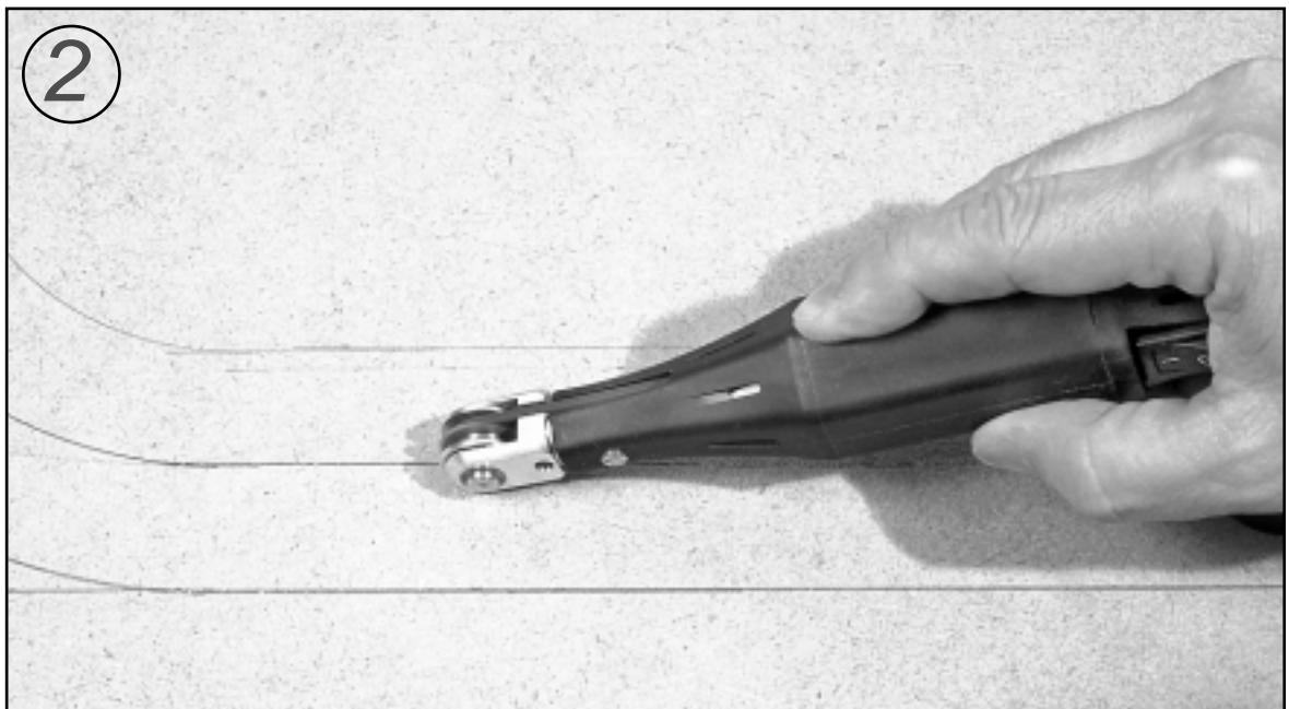
Mit der Rillenfräse fährt man nun diese Linie entlang und stellt die erforderliche Ausnutzung her. Hierbei ist darauf zu achten, daß immer beide Anschlagräder der Fräse auf dem Werkstück aufliegen, weil beim Schräghalten der Maschine nicht die für den Spezialdraht notwendigen Maße erzielt werden.
