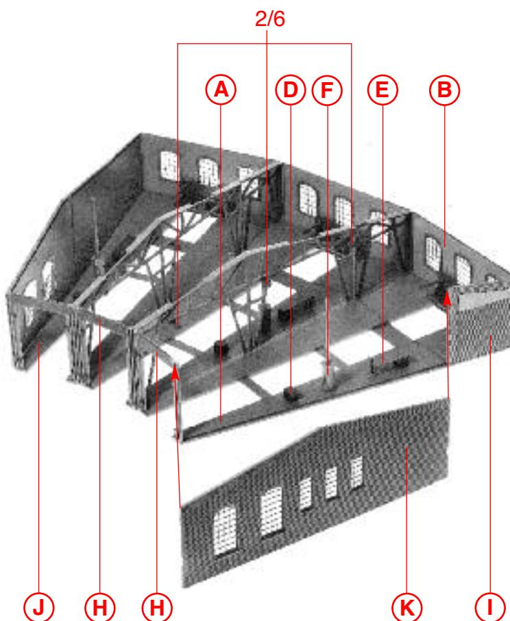
Wenn mehrere Lokschuppen aneinander gebaut werden sollen, Position I und K durch Teile 2/1, 8/1 und 8/2 ersetzen ( siehe Position J ).
