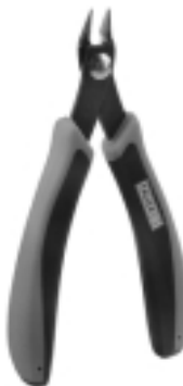
170688 Spezial-Seitenschneider zum gratfreien Abtrennen von feinsten Spritzteilen. Spitze 48° abgewinkelt. Nur für Polystyrol geeignet.
